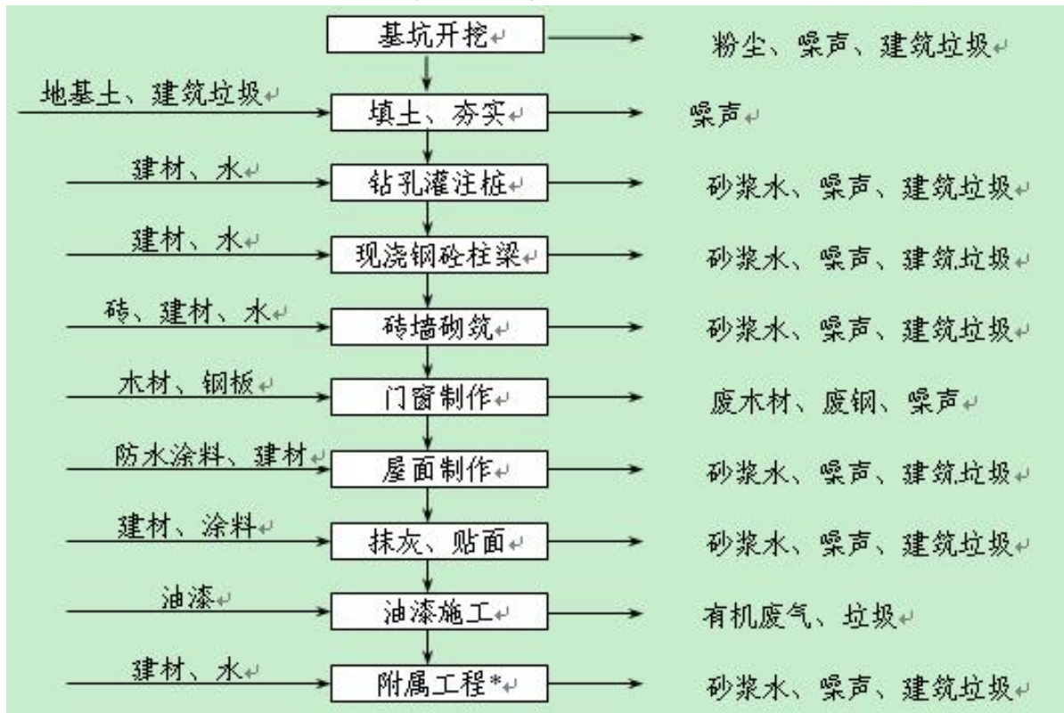
图 5-1 施工期建筑工艺流程图
