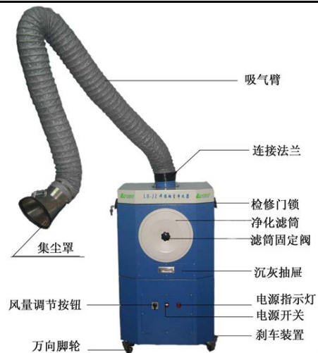
图 4-3 移动式焊接烟尘处理器结构简图
